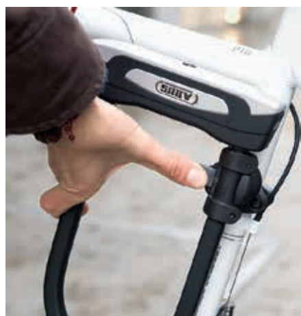
Sicher unterwegs. Eine gutsitzende Halterung sichert das Schloss während der Fahrt. Links Bügel-, rechts Faltschloss.
