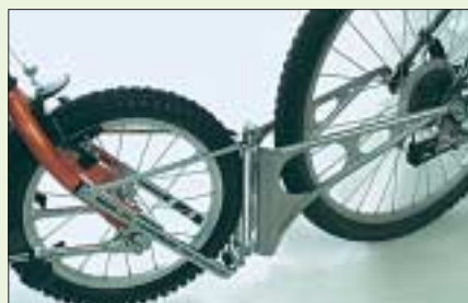
Auch der Gelenkverbinder Follow Me führt zu pendelnder Fahrweise. Material ist okay.
