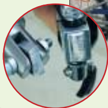
ZEG Flyke (im Bild) und Tchibo Fahrradtrailer: Bruch der Aufhängung in Fahrpraxis und Labor.
