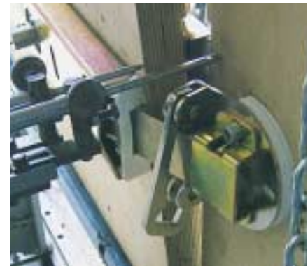
Der Panzerriegel beugt sich, bricht aber nicht. Im Labor wird von der Gegenseite gedrückt und die Spaltbreite gemessen.
